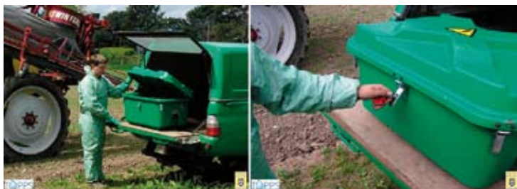
Slika 7. 2: Uporaba mobilnega skladišča za varen transport FFS do mesta uporabe (foto: TOPPS).
