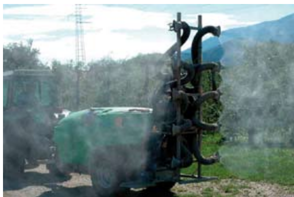
Slika 9. 5: Usmerjanje zračnega toka pri radialnih in pnevmatskih pršilnikih z usmerniki (M. Lešnik).
