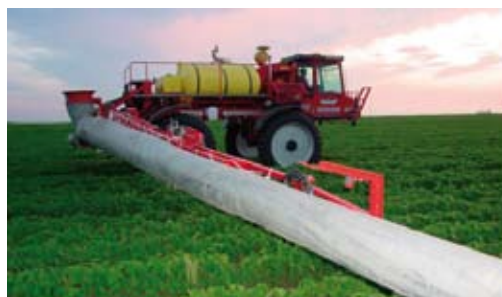
Slika 9.4: Škropilnica z zračno podporo (levo) (vir: http://www.desphares.ca/sectors-and-achievements/agricultural-equipment/?lang=en ) in nanašanje kapljic z zračno podporo (desno) (vir: Bernik, 2006)..
