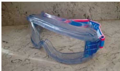
Slika 7. 28: Tesno prilegajoča se zaščitna očala (M. Bolčič Tavčar).
