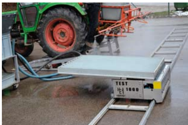
Slika 9.31: Testiranje naprav za nanašanje FFS: Pregled prečne porazdelitve škropilne brozge pri škropilnici (foto. M. Per).
