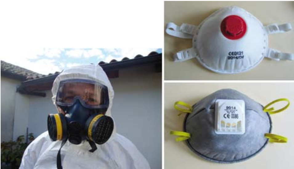
Slika 7. 29: Polmaska z možnostjo menjave filtrov (M. Bolčič Tavčar) in enostavna polmaska (J. Persolja).
