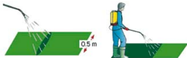
Slika 9. 19: Določanje umeritvene površine in višine šobe pri umeritvi (vir: http://www.hardi.co.uk/ ).
