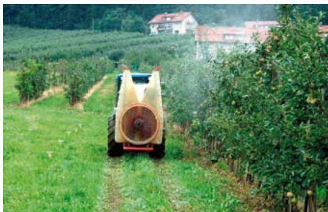
Slika 7.11: Enostransko nanašanje FFS v robnih vrstah nasada (M. Lešnik).
