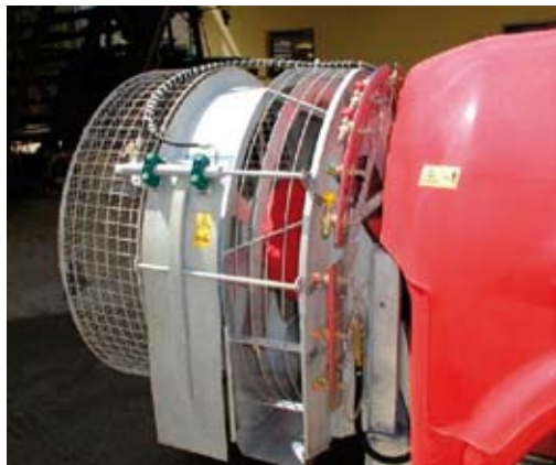
Slika 7.10: Pršilnik z nameščeno zračno zaporo ter vgrajenimi šobami za zmanjševanje zanašanja škropiva (G. Leskošek).
