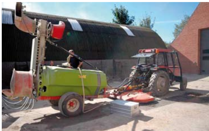
Slika 9. 8: Pršilnik z razdelilnim stolpom za zrak in s hidravlično gibljivimi usmerniki (foto: M. Lešnik)
